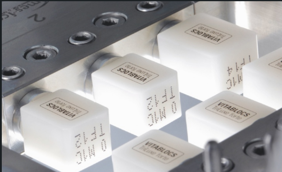
Abb. 9 und 10 Fräsen der Keramikveneers aus einer polychromen Feldspatkeramik.
