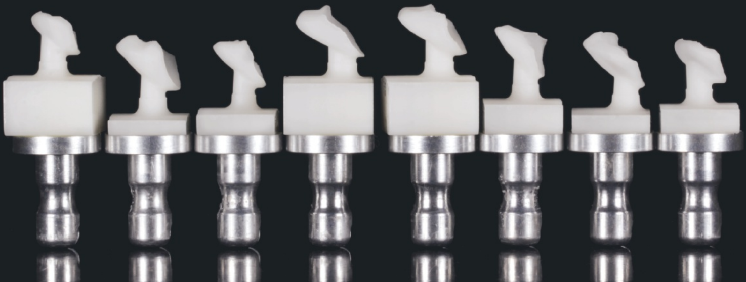
Abb. 9 und 10 Fräsen der Keramikveneers aus einer polychromen Feldspatkeramik.
